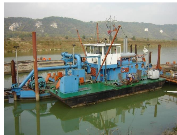
Ponton refouleur permettant le remblaiement de carrière
